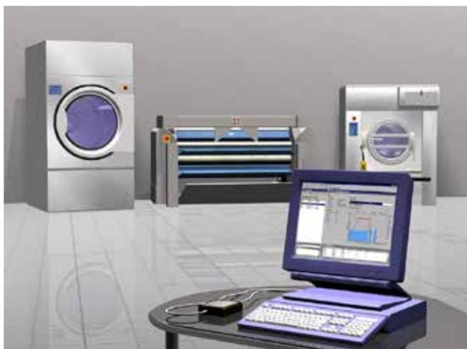
CMIS можно подключить к стиральным машинам с микропроцессорным управлением Clarus Control, сушильным барабанам с микропроцессорным управлением Selecta Control и гладильным каткам с электронной системой управления.
